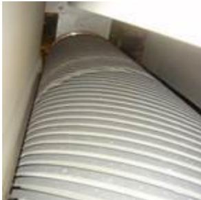
Контактные валы прорезинены, и если на станке ленты постоянно натянуты, а станок не работает, резина деформируется. Особенно это видно после долгих выходных или длительного простоя станка. В итоге работники производства, не понимая причины происходящего, видят утром после продолжительного отдыха станка с натянутой лентой на валах такую картину: на поверхности обработанной заготовки появляются дефекты или, как еще бывает, станок попросту трясется.
